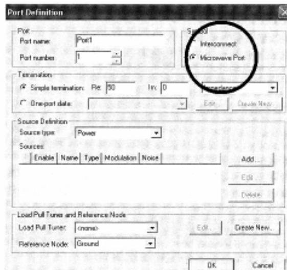
**Bild 14:** Zuerst werden die Ports von „Interconnect“ (das bedeutet einfach „Messpunkt“) auf echte Microwave Ports umgestellt
